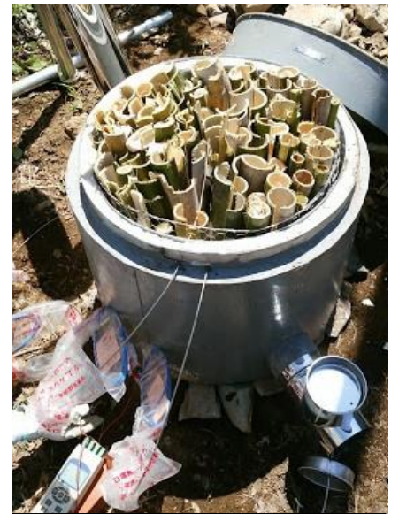
写真説明 宮城県の阿部さんが開発したドラム缶の窯。(特許取得済)材料は竹。この窯を使うと比較的短時間で焼くことができるので、体験プログラムとして有効に活用できる。これを大型化して生産することも可能で、希望が見えてきた。
